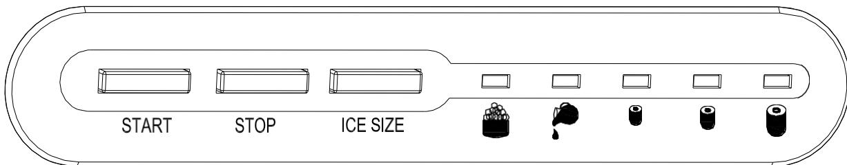
**'START'- en 'STOP'-toets:** Wanneer het apparaat van stroom wordt voorzien, zal deze op stand-by schakelen (moduslampje 'ijsselectie' zal knipperen); wanneer u op de toets '**START**' drukt (het betreffende ijsselectielampje zal op groen springen), begint het apparaat te werken. Wanneer u op de toets '**STOP**' drukt, zal het apparaat weer op stand-by schakelen;
