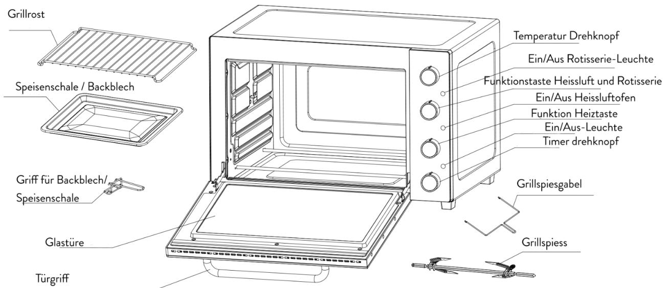
**Temperatur Drehknopf:** wählen Sie die gewünschte Temperatur von 90°C bis 230°C.
