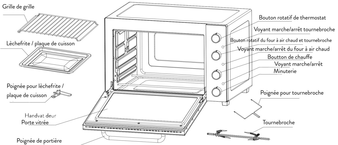
**Bouton rotatif de thermostat:** choisissez la température désirée de 90°C à 230°C.
